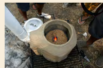
Stufa sperimentale a pirolisi in materiali naturali (terra e lolla)
